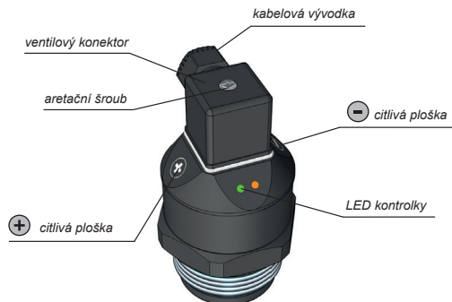
obr. 6: Popis hlavních částí snímače
