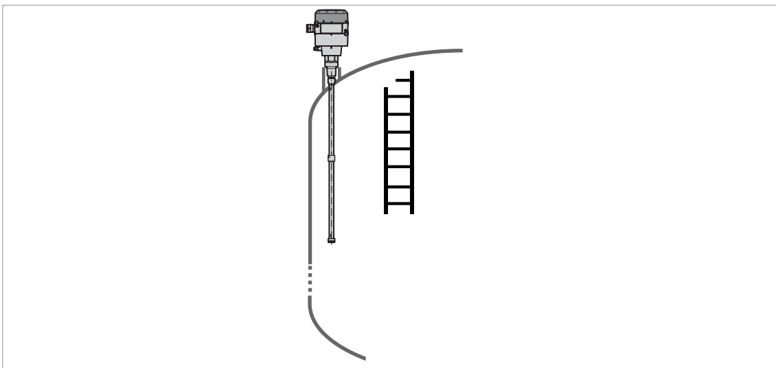
Obrázek 3-3: Souosý senzor: minimální vzdálenost od kovových stěn nádrže a kovových součástí vnitřní zástavby
