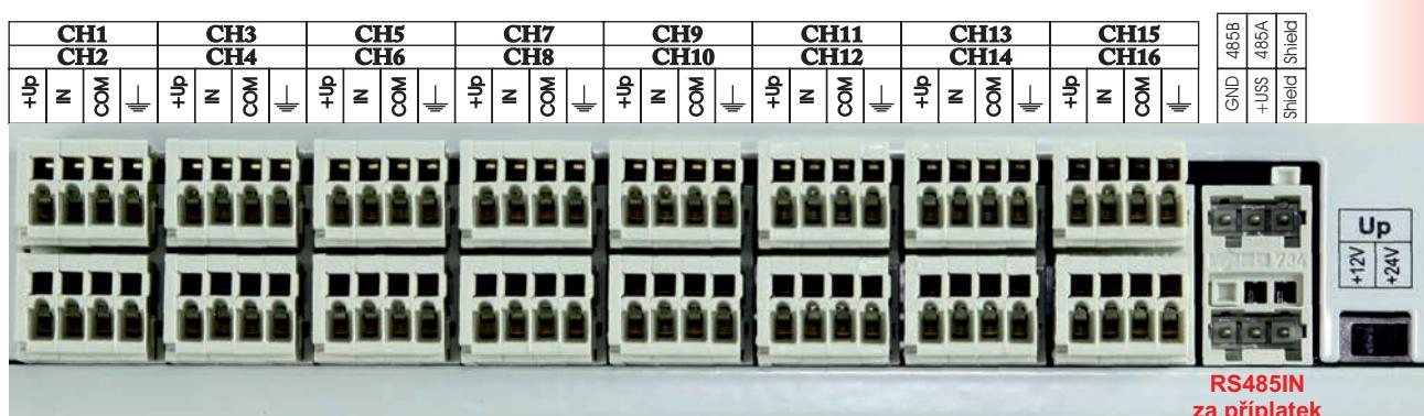
Vstupy ústředny s přepínačem napětí 12Vdc/24Vdc pro napájení připojených senzorů.
