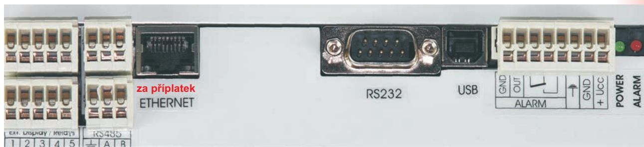
Komunikační rozhraní, alarmové výstupy, připojení napájení. Ethernetové rozhraní je za příplatek.
