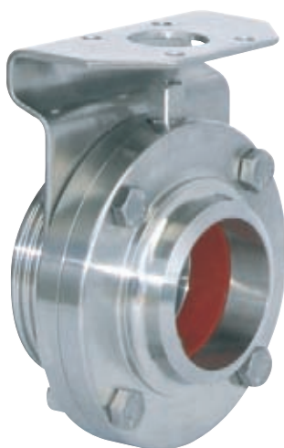
klapka v provedení S-G s konzolou dle ISO 5211 pro připojení pneu, nebo elektropohonu
