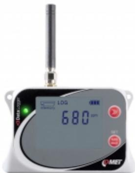
GSM datalogger je určen pro záznam CO<sub>2</sub> z vestavěného čidla. V případě překročení nastavených mezí umožňuje zasílání alarmových SMS a JSON zpráv přes GPRS datové připojení. Měřené hodnoty mohou být zasílány do internetového úložiště [COMET Cloud](#), což je kompletní monitorovací, alarmovací a analytický systém.
