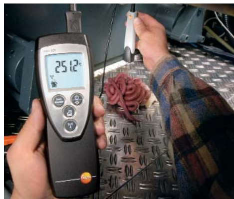
Měření teploty houževnatého plastického materiálu superychlou vpichovací sondou, ideální pro umělé hmoty, potraviny atd.
