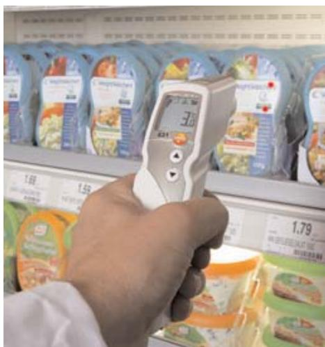
Při kontrole teploty zboží v regálu ohraničuje dvoubodový laser přesně místo, které měříte a zároveň ukazuje i jeho velikost.
