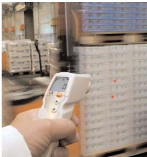
Typickým příkladem použití je rychlá kontrola teploty potravin při příjmu zboží, v prodejných regálech, lednicích nebo ve výrobě.
