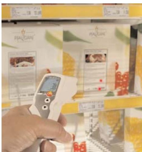
Uživatelem nastavitelná hranice alarmu umožňuje automatické upozornění na teplotní neshody. Při překročení/podkročení nastavené hodnoty se spustí akustický alarm a na displeji začne blikat nápis "Alarm".
