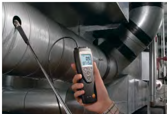
testo 416 při zjišťování objemového průtoku odsávaného vzduchu
