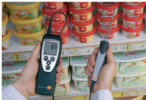
Kontrola chladicího pultu, zda je jeho chladicí výkon dostačující
